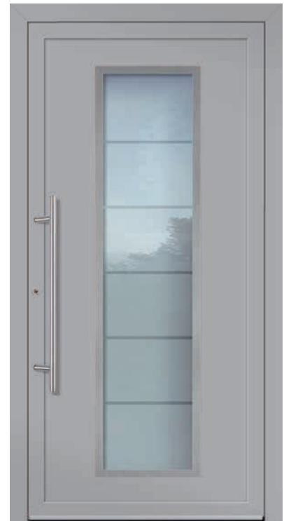
1) E 34 U_g -Wert 1,25 1) Farbe: RAL 9006 Weißaluminium FS Verglasung: Mattiert mit klaren Streifen LA 360 x 1.600 mm Rahmen in Edelstahl optik außen Mindestmaß = 800 x 1.990 mm
