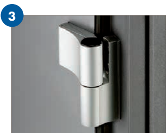
3 BÄNDER (3 STÜCK) 1) Aufliegende zweiteilige Türbänder, dreidimensional verstellbar, in EV1, Tragkraft bis 160 kg Flügelgewicht pro Band
